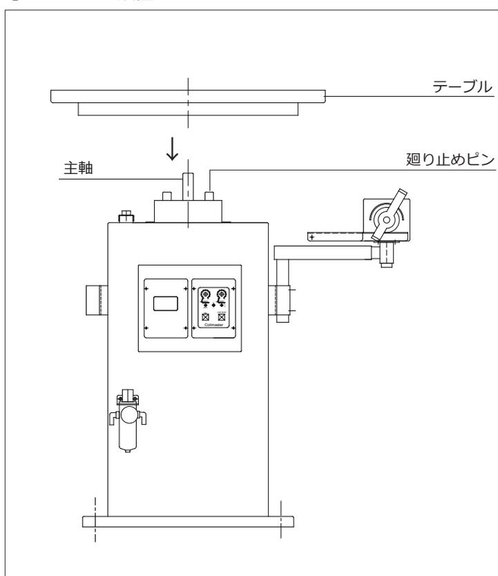
主軸及び廻り止めピンの位置を合わせてテーブルを載せてください。
