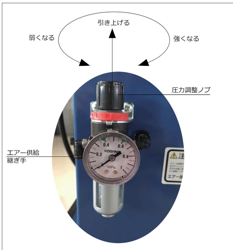
張力の調整は、圧力調整ノブを引き上げ時計方向に回すと強く、反時計方向に回すと弱くなります。
