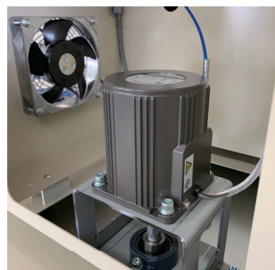
攪拌ファンのダイレクト駆動化及び冷却ファンを追加
