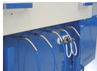
温度分布測定用窓を装備。定期的な温度分布測定が可能。
