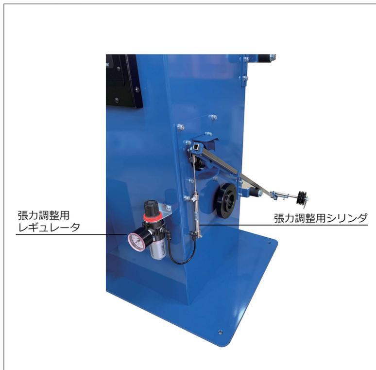
エアーの供給は、フィルターレギュレータ (FRユニット)左側の継ぎ手にφ6エアーチューブを接続し供給してください。
